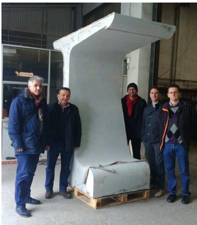
**Imagen 5. Estructura de madera del prototipo tratada para generar el molde a partir del cual se produjo la estructura principal. A la izquierda, junto a parte del equipo de investigadores de AIDIMME e ITC-AICE, está el arquitecto austriaco Kiyanshid Hedjri.**
