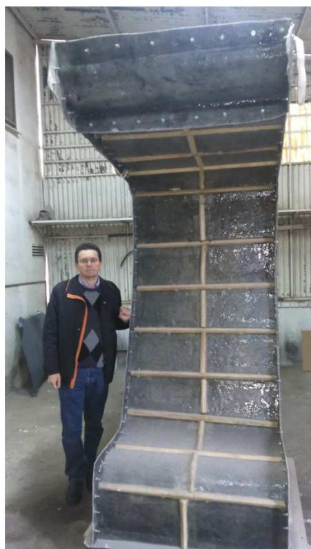
**Imagen 6. Estructura principal del prototipo, que está hecha en fibra de vidrio de 8 mm. Sobre esta estructura principal, una vez pulida y pintada, se ha instalado la cerámica autolimpiante y la madera tratada.**
