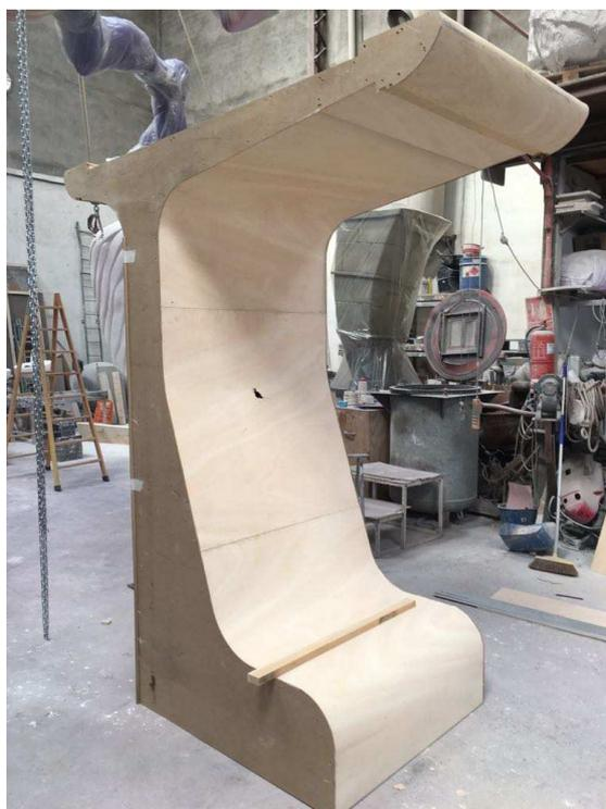
***Imagen 4. Estructura de madera del prototipo, desarrollada para la comprobación de medidas y que se usó como base para desarrollar el molde de la estructura.***
