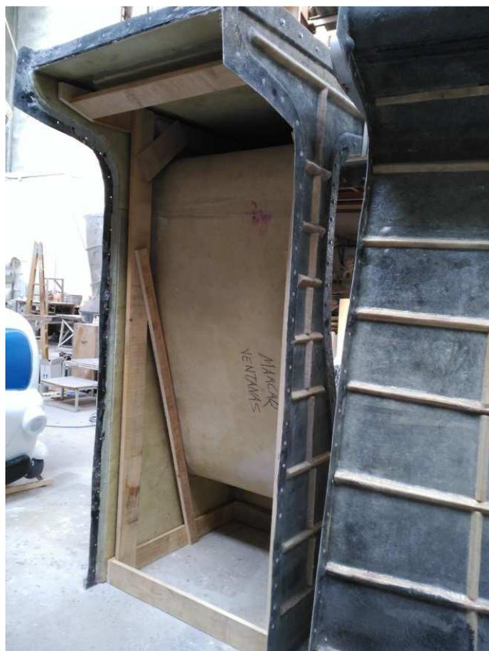
**Imagen 8. La estructura secundaria metálica va colocada en el interior de la estructura principal.**
